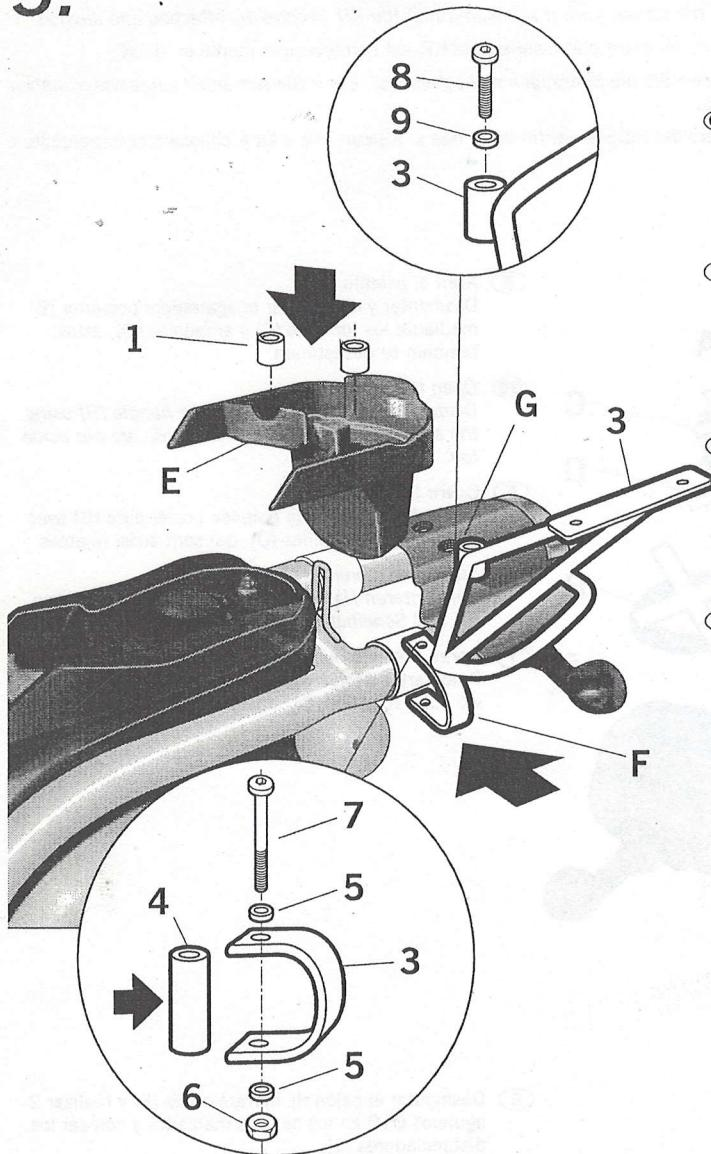
(E) Posicionar los soportes KIT TOP (3) en zona (F), volver a colocar el cajón de herramientas (E) y fijarlo todo mediante los distanciadores (4) las arandelas (5), las tuercas (6) y los tornillos (7). Y en zona (G) mediante los tornillos (8) y arandelas (9). Cerrar el asiento (A).
